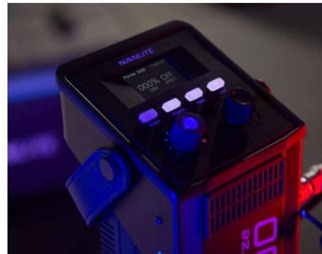
Функция мгновенного уменьшения яркости от 100 % до 1 % позволяет практически мгновенно диммировать светильник согласно партитуре, без добавления ND-фильтров или диффузии. Применение COB излучателя, в сочетании с линзой Френеля или шторками, позволяет получать «жесткое» световое пятно с четкими границами, что раскрывает новые возможности.
