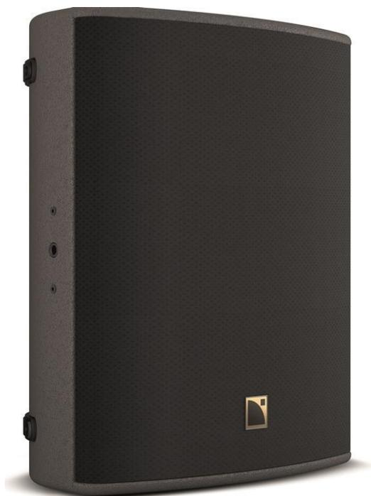
**X12 – акустическая система (fullrange) с номинальным сопротивлением 8 Ом в корпусе с фазоинвертором, где компрессионный драйвер с диафрагмой в 3", расположен коаксиально относительно НЧ/СЧ 12-дюймового динамика. Диапазон рабочих частот составляет от 59 Гц до 20 кГц. X12 имеет встроенный оригинальный пассивный кроссовер.**
