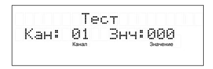
Кнопки < ◀ > и < ▶ > устанавливают канал, а < ▲ > и < ▼ > изменяют значение для него. Ключевое слово "Все" позволяет производить управление всеми каналами одновременно. Нажатие кнопок <Enter> или <Menu> позволяет выйти из режима.
